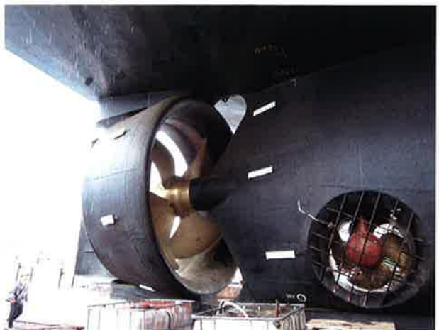
写真3 欧州漁船の典型的なコルトノズル
