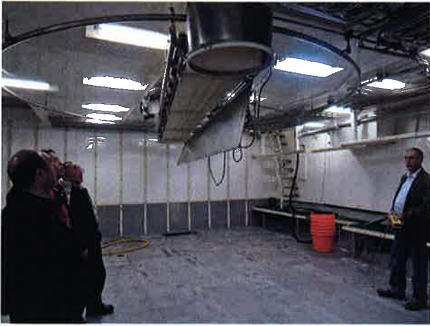
写真19 回転式コンベアで漁獲物を魚倉に入れる
